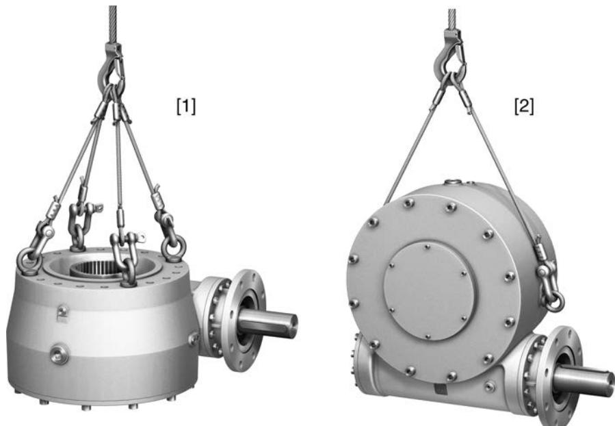
[1] Крепление для транспортировки в горизонтальном положении
