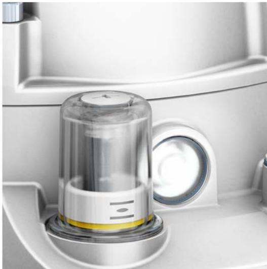
Bei der ersten Fahrt in Richtung AUF schiebt die gelbe Positionsanzeigescheibe den weißen Endlagenanzeigering nach oben bis die Endlage erreicht ist.
