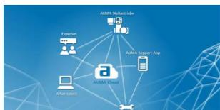
Die AUMA Assistant App ermöglicht die Fern-Einstellung und Fern-Diagnose von AUMA Stellantrieben per Bluetooth mit einem Smartphone oder einem Tablet.
