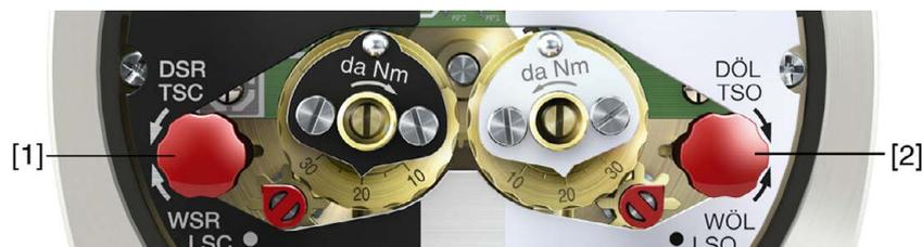
1. Testknopf [1] in Pfeilrichtung DSR drehen: Drehmomentschalter ZU löst aus.
