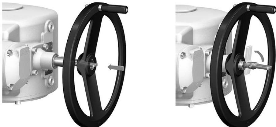
3. Umschalthebel loslassen (schwenkt durch Federkraft in Ausgangslage zurück, gegebenenfalls mit der Hand nachhelfen).
