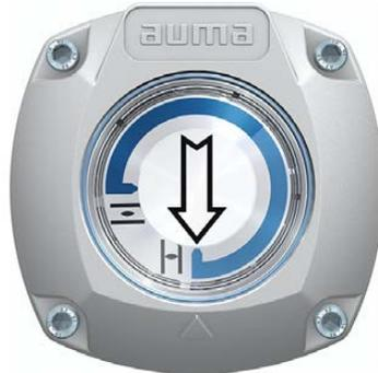
Bei Ausführung mit selbsteinstellender mechanischer Stellungsanzeige stellt sich diese mit der ersten Fahrt (z.B. von ZU nach AUF) selbst ein. Diese Selbsteinstellung erfolgt i.d.R. bereits mit Einstellung der Wegschaltung (Anfahren der Endlagen). Eine manuelle Einstellung und somit ein Öffnen des Schaltwerkraums ist bei der Inbetriebnahme daher nicht erforderlich.
