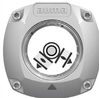
Die mechanische Stellungsanzeige zeigt die Armaturenstellung über zwei Anzeigescheiben mit den Symbolen  $\overline{\text{AUF}}$  (AUF) und  $\underline{\text{ZU}}$  (ZU). Bei korrekter Einstellung zeigen die Symbole AUF/ZU in den Endlagen auf die Anzeigemarke  $\blacktriangle$  am Deckel.
