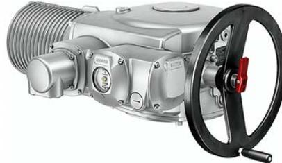
AUMA Drehantriebe SA 25.1 – SA 48.1/SAR 25.1 – SAR 30.1 werden elektromotorisch angetrieben und können in Verbindung mit der Anschlussform A Schubkräfte aufnehmen. Für manuelle Betätigung ist ein Handrad vorhanden. Die Abschaltung in den Endlagen kann weg- oder drehmomentabhängig erfolgen. Zur Ansteuerung bzw. zur Verarbeitung der Antriebssignale ist eine Stellantriebs-Steuerung unbedingt erforderlich.
