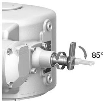
2. Handrad über roten Umschalthebel auf Welle aufstecken.
