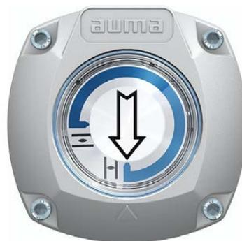
Die selbsteinstellende mechanische Stellungsanzeige zeigt die Armaturenstellung über einen Pfeil  $\Rightarrow$ . Bei korrekter Einstellung zeigt der Pfeil in den Endlagen auf das Symbol  $\equiv$  (AUF) bzw.  $\perp$  (ZU).
