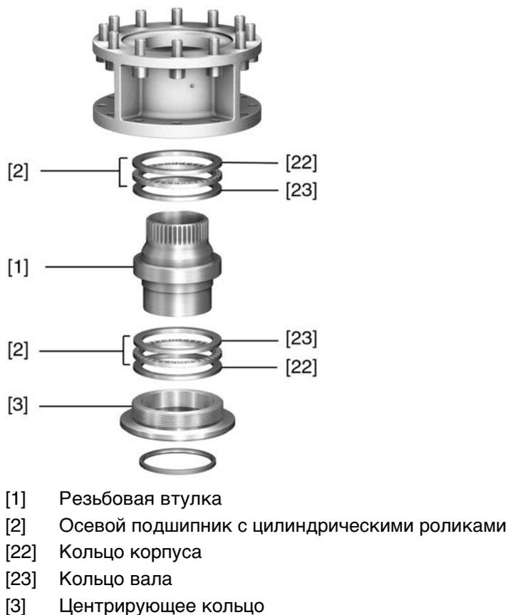
1. Снять с соединительной муфты центрирующее кольцо [3].
