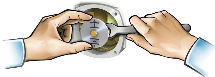
2. Anhand der Tabelle überprüfen, ob der Schwenkwinkel des Stellantriebs mit der Einstellung des Untersetzungsgetriebes (Stufen 1 – 9) übereinstimmt.
