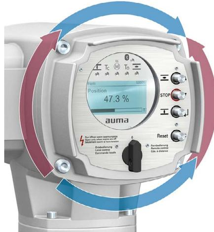
Die Montageposition der Ortssteuerstelle wird entsprechend der Bestellung ausgeführt. Sollte nach dem Anbau an die Armatur bzw. an das Getriebe, vor Ort, die Ortssteuerstelle ungünstig positioniert sein, kann die Position auch nachträglich geändert werden. Hierzu sind vier um 90° gedrehte Positionen möglich (maximal um 180° in eine Richtung).
