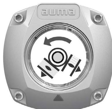
Die mechanische Stellungsanzeige zeigt die Armaturenstellung über zwei Anzeigescheiben mit den Symbolen (AUF) und (ZU). Bei korrekter Einstellung zeigen die Symbole AUF/ZU in den Endlagen auf die Anzeigemarke am Deckel.
