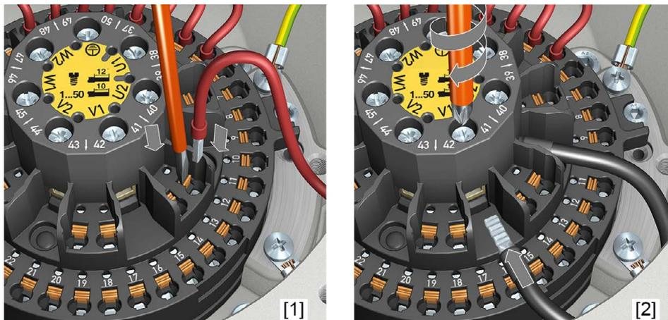
[1] Befestigung von Steuerleitungen mit Federkraftklemmen
