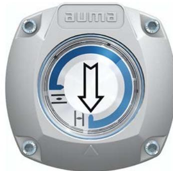
Die selbsteinstellende mechanische Stellungsanzeige zeigt die Armaturenstellung über einen Pfeil  $\rightleftarrows$ . Bei korrekter Einstellung zeigt der Pfeil in den Endlagen auf das Symbol  $\equiv$  (AUF) bzw.  $\perp$  (ZU).
