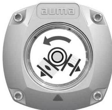
Die mechanische Stellungsanzeige zeigt die Armaturenstellung über zwei Anzeigescheiben mit den Symbolen **AUF** (AUF) und **ZU** (ZU). Bei korrekter Einstellung zeigen die Symbole AUF/ZU in den Endlagen auf die Anzeigemarke **▲** am Deckel.
