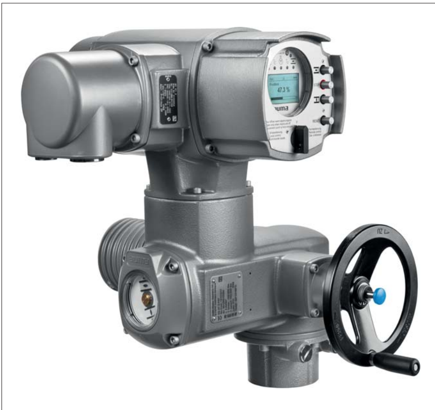
Ilustracja 7. Obecnie produkowany napęd firmy AUMA wyposażony w inteligentną diagnostykę oraz różne możliwości podłączenia magistrali obiektowej, a także w ramę z podwójnym uszczelnieniem
