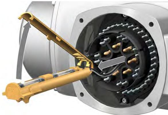
2. Sicherungshalter aus Stiftteil herausziehen, Sicherungsdeckel öffnen und alte Sicherungen durch neue Sicherungen austauschen.
