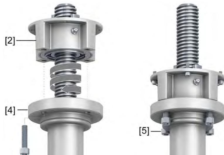
6. Drehantrieb so auf Armaturenspindel aufsetzen, dass die Mitnehmer der Gewindebuchse in die Abtriebshülse eingreifen.
