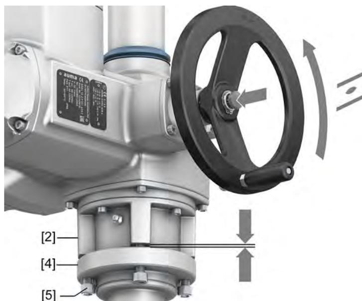
11. Schrauben [5] zwischen Armatur und Anschlussform A über Kreuz mit Drehmoment nach Tabelle anziehen.
