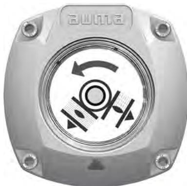
Die mechanische Stellungsanzeige zeigt die Armaturenstellung über zwei Anzeigescheiben mit den Symbolen  $\triangle$  (AUF) und  $\square$  (ZU). Bei korrekter Einstellung zeigen die Symbole AUF/ZU in den Endlagen auf die Anzeigemarke  $\blacktriangle$  am Deckel.
