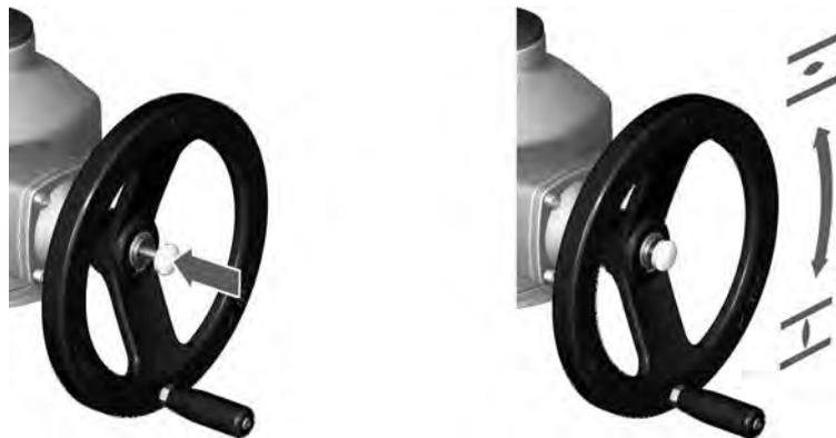
→ Die Schließrichtung ist auf dem Handrad gekennzeichnet:
