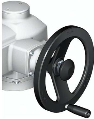
Bei Stellantrieben in der Ausführung mit dauerhaft montiertem Handrad ist das Handrad zur Bedienung für Einstellarbeiten und zur Notbetätigung des Stellantriebs vorgesehen. Das Handrad ist auch bei Überflutung zugelassen. Die Handradumschaltung ist durch einen speziellen Faltenbalg gegen Ablagerungen geschützt.
