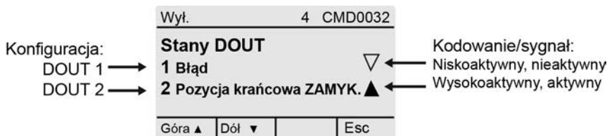
Rysunek 57: Przykład DOUT 1 i DOUT 2
