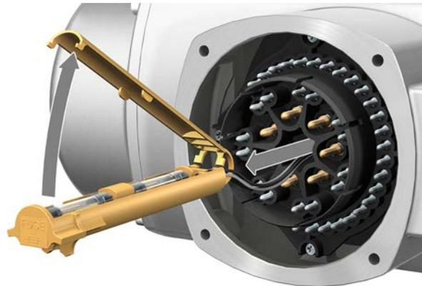
2. Sicherungshalter aus Stifteil herausziehen, Sicherungsdeckel öffnen und alte Sicherungen durch neue Sicherungen austauschen.
