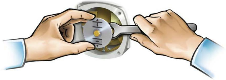
2. Anhand der Tabelle überprüfen, ob U/Hub des Stellantriebs mit der Einstellung des Untersetzungsgetriebes (Stufen 1 – 9) übereinstimmt.
