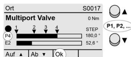
Über die Drucktaster ▲▼ die gewünschte Position (P1, P2, ...) auswählen und über OK (Drucktaster ◀▶) die Auswahl bestätigen.
