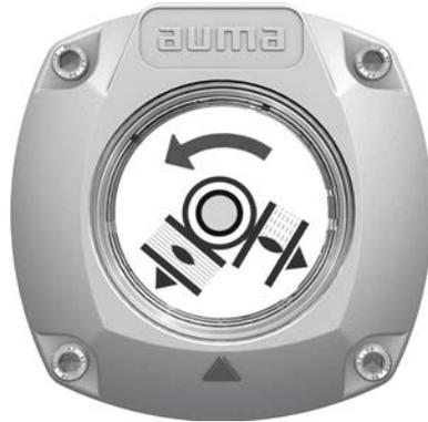
Die mechanische Stellungsanzeige zeigt die Armaturenstellung über zwei Anzeigescheiben mit den Symbolen  $\overline{\text{AUF}}$  (AUF) und  $\overline{\text{ZU}}$  (ZU). Bei korrekter Einstellung zeigen die Symbole AUF/ZU in den Endlagen auf die Anzeigemarke  $\blacktriangle$  am Deckel.
