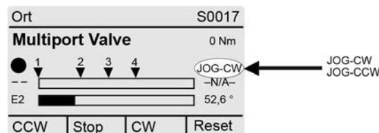
Damit kann die Armatur in oder gegen den Uhrzeigersinn gefahren werden (Anzeige CW bzw. CCW).
