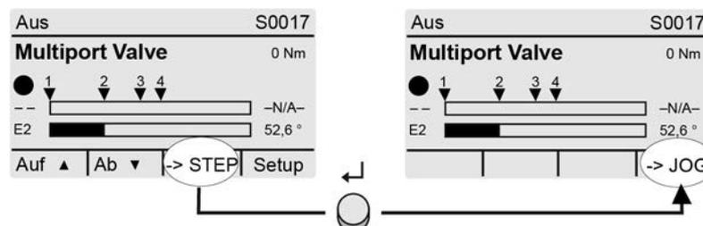
Durch Umschalten des Wahlschalters in die Stellung **Ortsbedienung** (ORT) ändert sich die Displayanzeige zur Auswahl der gewünschten Position.
