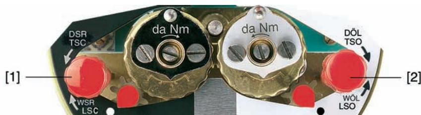
1. Testknopf [1] in Pfeilrichtung DSR drehen: Drehmomentschalter ZU löst aus. Die Meldeleuchte Drehmomentfehler ZU auf der Ortssteuerstelle leuchtet.
