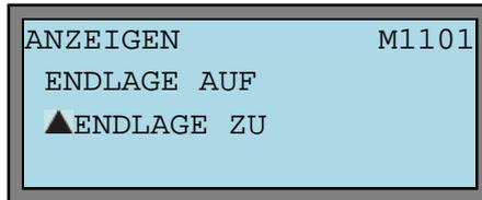
Mit ▲ und ▼ kann zwischen M1100 ENDLAGE AUF und M1101 ENDLAGE ZU gewechselt werden.
