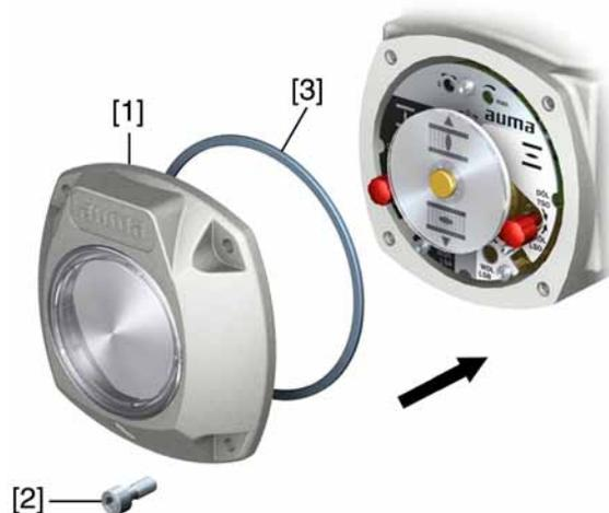
4. Deckel [1] am Schaltwerkraum aufsetzen.
