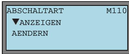
Mit ▲ und ▼ kann zwischen ANZEIGEN und AENDERN gewechselt werden.
