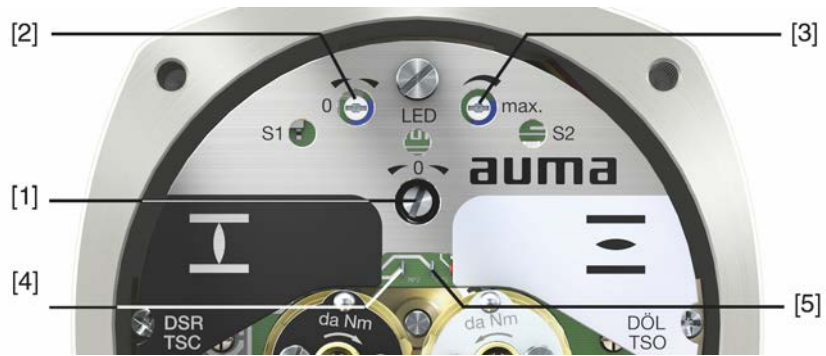
Bild 72: Blick auf Steuereinheit bei geöffnetem Schaltwerkraum
