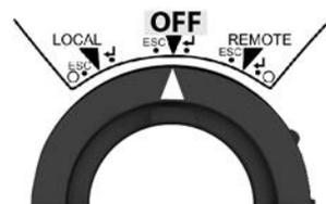
Der Wahlschalter ist kein Netzschalter. In der Stellung **OFF** wird die Ansteuerung des Stellantriebs verhindert. Die Spannungsversorgung des Stellantriebs bleibt bestehen.
