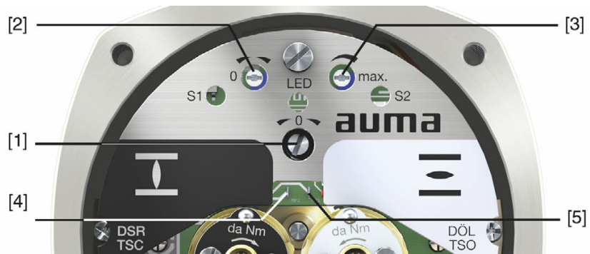
Bild 26: Blick auf Steuereinheit bei geöffnetem Schaltwerkraum
