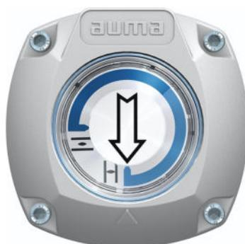
Die selbsteinstellende mechanische Stellungsanzeige zeigt die Armaturenstellung über einen Pfeil  $\rightleftarrows$ . Bei korrekter Einstellung zeigt der Pfeil in den Endlagen auf das Symbol  $\overline{\text{H}}$  (AUF) bzw.  $\underline{\text{H}}$  (ZU).
