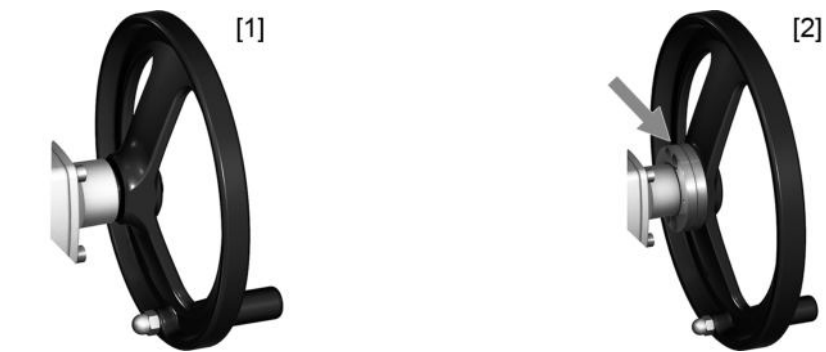
Bild 40: Handrad ohne/mit Überlastschutz
