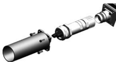
рис. 9: Монтаж защитных втулок (опция)
