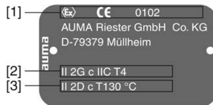
Fig. 3: Kontrolskilt for eksplosionsbeskyttelsesudførelse (eksempel)
