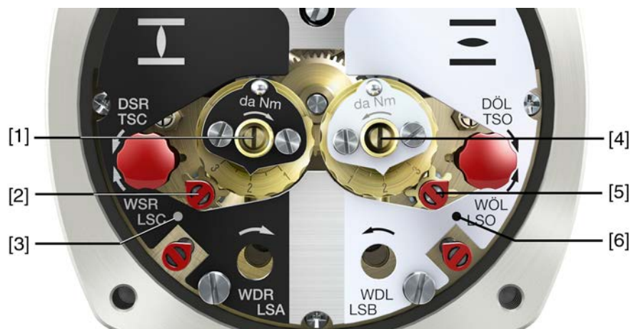
Rysunek 71: Elementy nastawcze wyłącznika krańcowego
