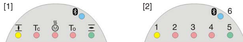
Rysunek 68: Rozmieszczenie i znaczenie diod sygnalizacyjnych
