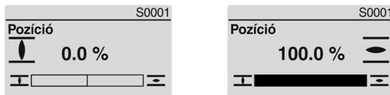
Ábra 51: ZÁRVA/NYITVA véghelyzet elérve
