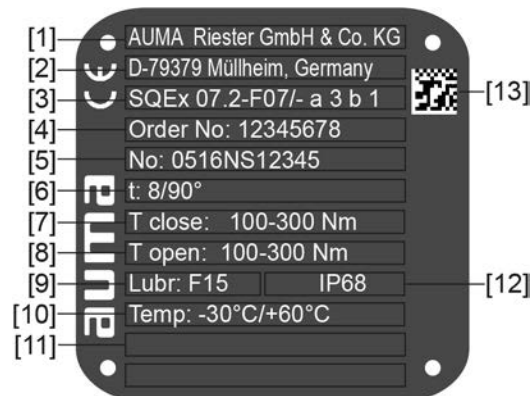
Ábra 5: Állítómű típustáblája (példa)
