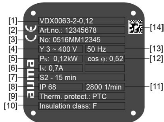
Ábra 6: Motor típus tábla (példa)
