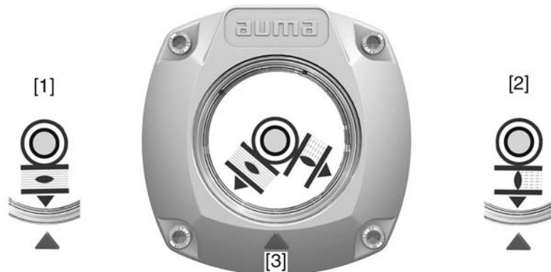
Figure 61 : Indicateur de position mécanique
