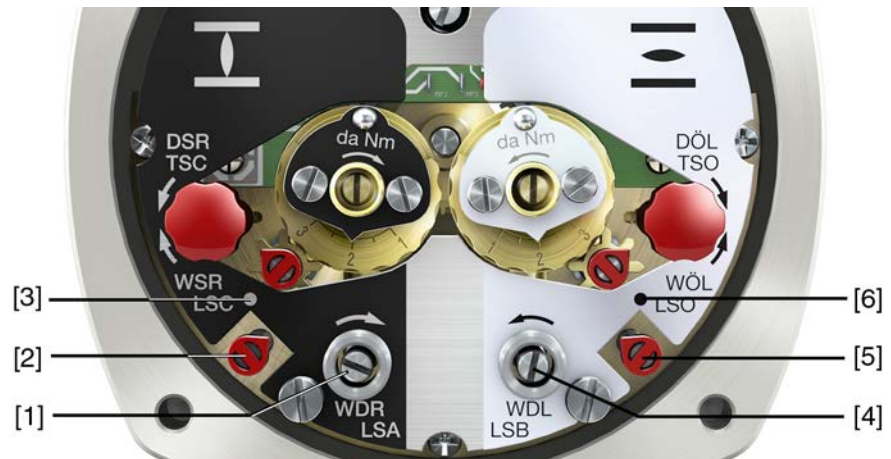
Figure 66 : Eléments de réglage pour les contacts fin de course
