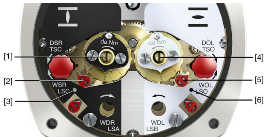
Figure 65 : Eléments de réglage pour les contacts fin de course
