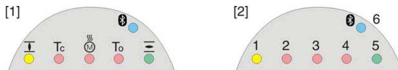
Figure 60 : Disposition et signification des voyants d'indication
