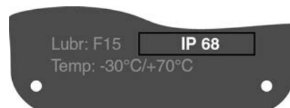
Figure 23 : Exemple : Plaque signalétique IP68
