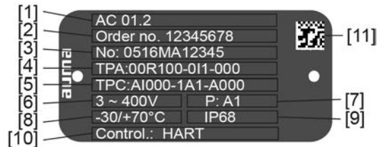
Rysunek 6: Tabliczka znamionowa sterownika napędu ustawczego (przykład)
