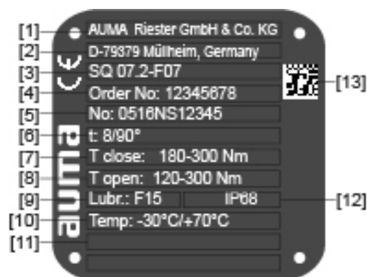
Rysunek 5: Tabliczka znamionowa napędu ustawczego (przykład)
