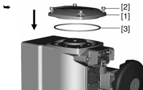
5. Deckel [1] am Schaltwerkraum aufsetzen.
