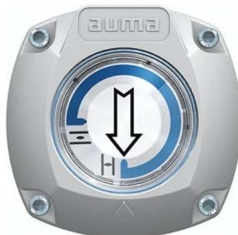
Die selbst-einstellende mechanische Stellungsanzeige zeigt die Armaturenstellung über einen Pfeil ⇄. Bei korrekter Einstellung zeigt der Pfeil in den Endlagen auf das Symbol (AUF) bzw. (ZU).
