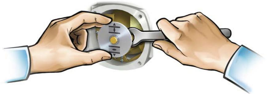
2. Anhand der Tabelle überprüfen, ob der Schwenkwinkel des Stellantriebs mit der Einstellung des Untersetzungsgetriebes (Stufen 1 – 9) übereinstimmt.
