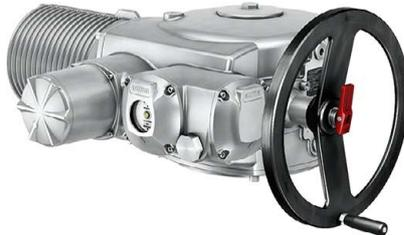
AUMA Drehantriebe SAEx 25.1 – SAEx 30.1/SAREx 25.1 – SAREx 30.1 werden elektromotorisch angetrieben und können in Verbindung mit der Anschlussform A Schubkräfte aufnehmen. Für manuelle Betätigung ist ein Handrad vorhanden. Die Abschaltung in den Endlagen kann weg- oder drehmomentabhängig erfolgen. Zur Ansteuerung bzw. zur Verarbeitung der Antriebssignale ist eine Stellantriebs-Steuerung unbedingt erforderlich.
