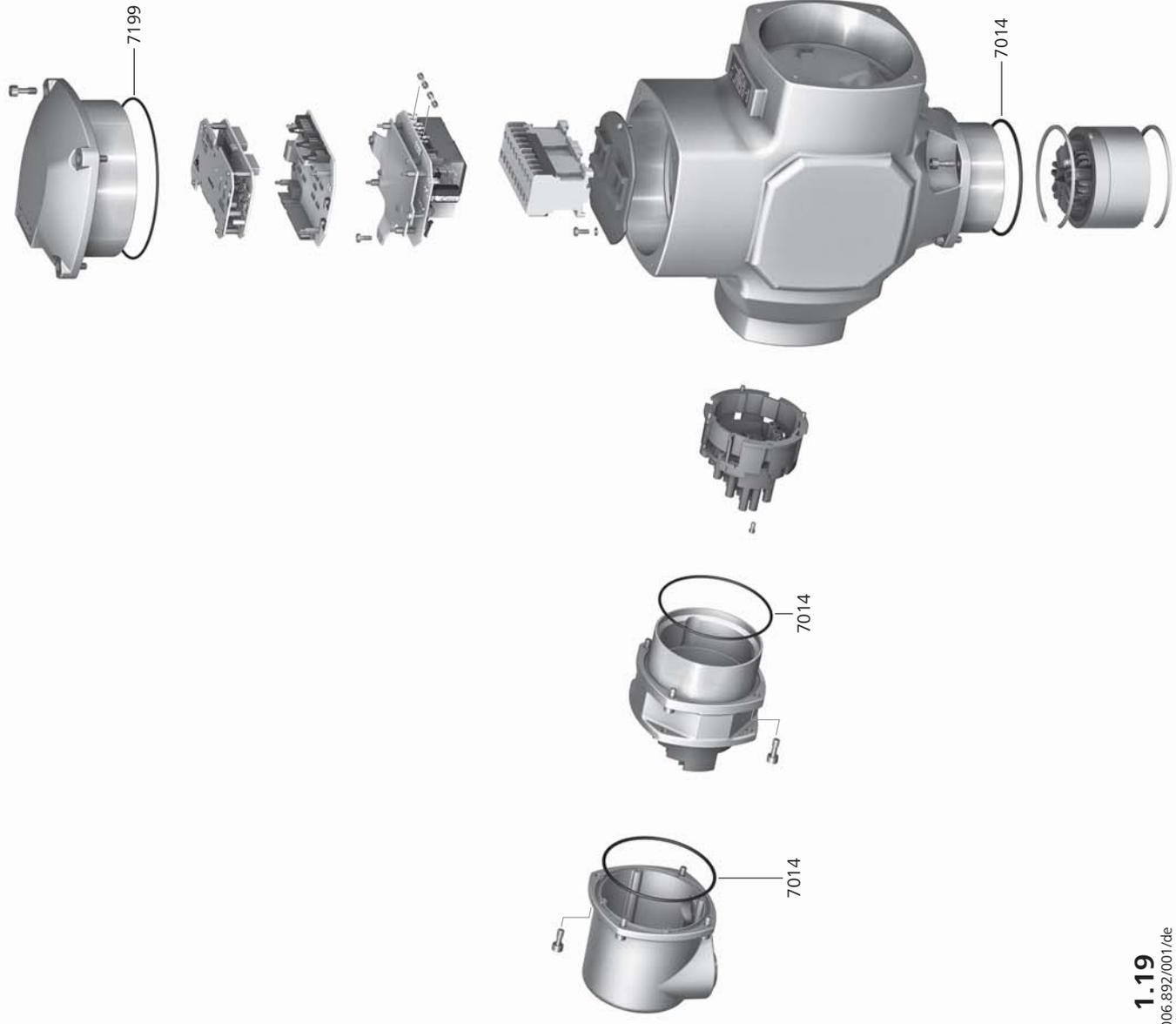
**Ersatzteilliste Dichtungen für AUMA MATIC**
