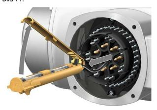
2. Sicherungshalter aus Stiftteil herausziehen, Sicherungsdeckel öffnen und alte Sicherungen durch neue Sicherungen austauschen.
