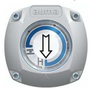
Die selbsteinstellende mechanische Stellungsanzeige zeigt die Armaturenstellung über einen Pfeil  $\Longrightarrow$ . Bei korrekter Einstellung zeigt der Pfeil in den Endlagen auf das Symbol  $\stackrel{\frown}{=}$  (AUF) bzw.  $\stackrel{\frown}{\perp}$  (ZU).
