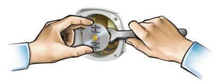
Anhand der Tabelle überprüfen, ob der Schwenkwinkel des Stellantriebs mit der Einstellung des Untersetzungsgetriebes (Stufen 1 – 9) übereinstimmt.
