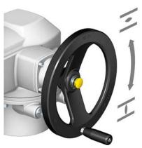
Die Schließrichtung ist auf dem Handrad gekennzeichnet:
