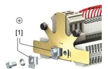
[1] Klemmbügel für Schutzleiteranschluss
