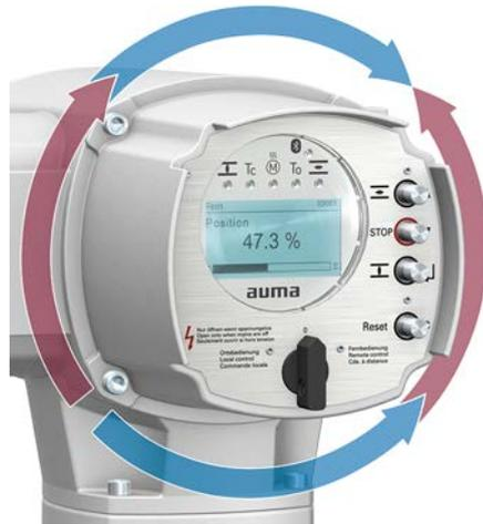
La position de montage de la commande locale est réalisée selon les indications de l'accusé de réception. Il est possible de modifier la position ultérieurement sur site, si après le montage sur la vanne ou le réducteur la position de la commande locale n'est pas optimale. A cet effet, 4 positions de montage décalées respectivement par 90° sont possibles (maximum 180° dans une direction).
