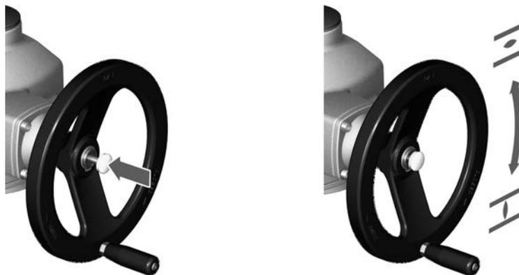
➔ La direction de fermeture est marquée sur le volant :
