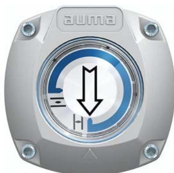
L'indicateur de position mécanique à réglage automatique montre la position de la vanne à l'aide d'une flèche  $\Downarrow$ . Lors d'un réglage correct, la flèche pointe sur le symbole  $\equiv$  (OUVERT) ou  $\perp$  (FERME) en position finales.
