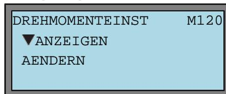
Mit ▲ und ▼ kann zwischen ANZEIGEN und AENDERN gewechselt werden.
