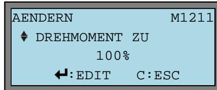
Mit **▲** und **▼** kann zwischen DREHMOMENT AUF und DREHMOMENT ZU gewechselt werden.
