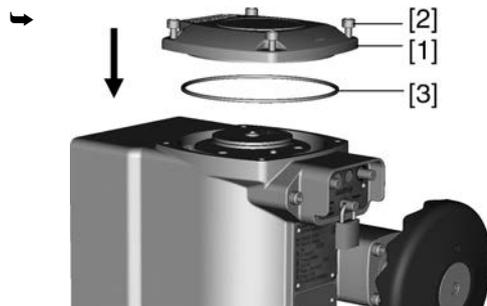
5. Placer le capot [1] sur le boîtier de commande.
